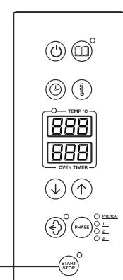
An diesem Punkt wird der Ofen auf der Vorwärmtemperatur gehalten, bis die Tür geöffnet ist, um die Garprodukte zuzuführen. Ab dem Schließen der Ofentür beginnt das Garen mit Phase 1.
