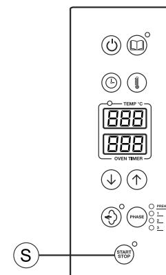
De PREHEAT-leds naast de PHASE-toets en naast de Start/Stop-toets zullen oplichten.
