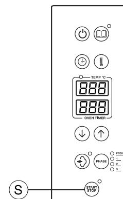
Si on ouvre la porte pendant le préchauffage (avant de rejoindre la température établie), cette phase est automatiquement interrompue, car on présume qu'on a mis au four des aliments.
